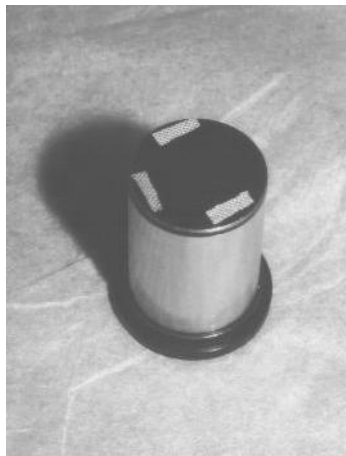
Foto XXXIX Afwijkende plaatsing van de oculairmicrometer tbv. fotografie
