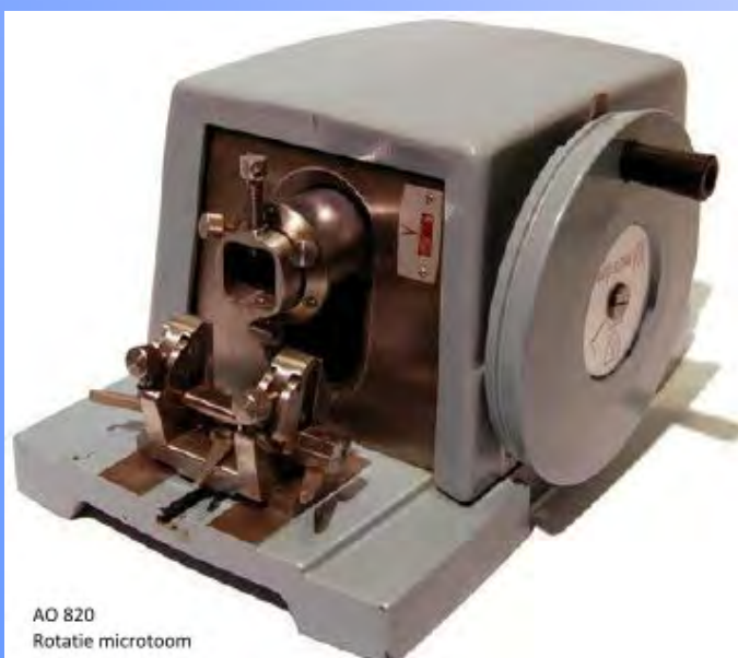
figuur 1 microtoom met een meshouder voor vaste messen
